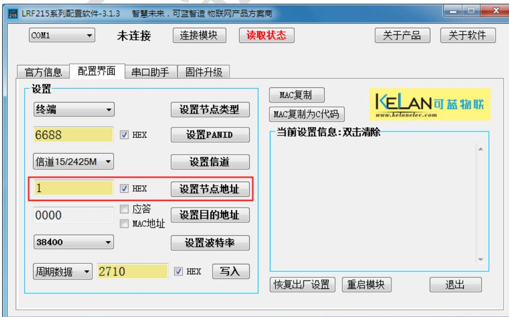
节点地址的作用：数据接收端收到的每条数据里面都会带有相应传感器采集器的节点地址，在多个节点同时存在的情况下，用于分辨是哪个节点发送过来的数据。
